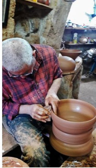
Şekil 7: İlk parçanın kalıp üzerine yerleştirilmesi ve ikinci parça ile birleştirilmesi için hazırlanması (Toğrul, 2018)
