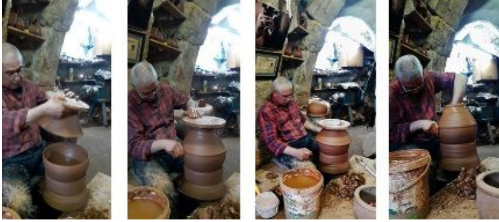
Şekil 8: Udunun iki parçasının birbirine birleştirilmesi (Toğrul, 2018)
