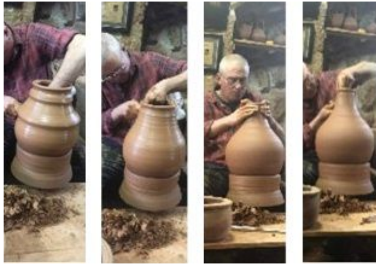
Şekil 9: Birleşen parçalara udu şeklinin verilmesi (Toğrul, 2018)
