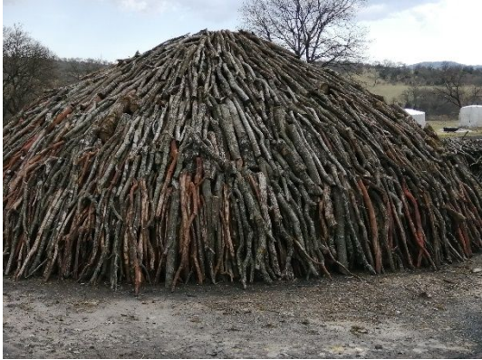
Foto 3-4: Odunların ortasında baca oluşturacak şekilde dizildiği ve yanmanın dengeli olabilmesi için havalandırma delikleri açılan odun kömürü ocağı
