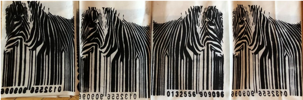
Şekil 12: Çizgili baskının deneysel sonuçları (soldan sağa 77T, 90T, 120T ve 140T )
