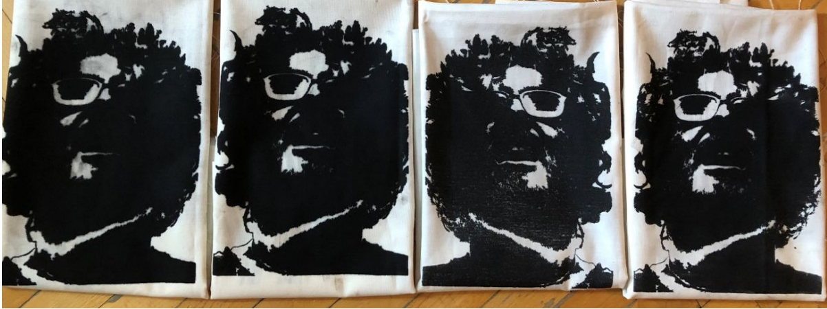
Şekil 19: Siyah beyaz fotoğraf baskımın deneysel sonuçları (soldan sağa 77T, 90T, 120T ve 140T )
