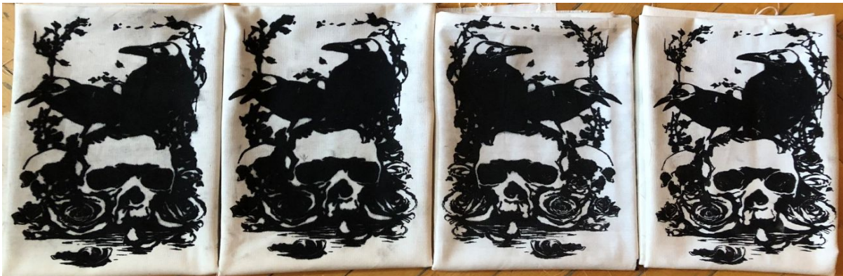
Şekil 17: İllüstrasyon baskının deneysel sonuçları (soldan sağa 77T, 90T, 120T ve 140T )
