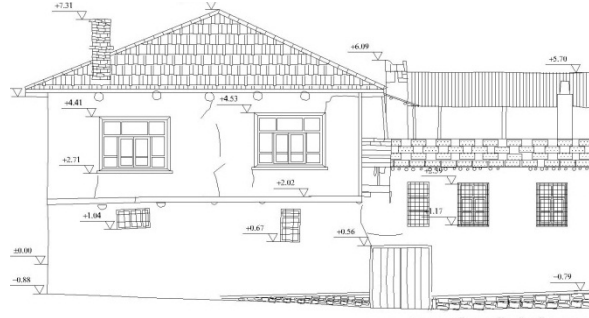
Şekil 8.Figen Köprülü Evi batı cephesi rölövesi
