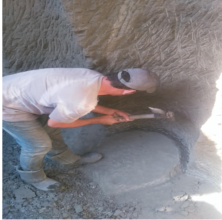
Foto 3: Pergel ile çizilen kalıp kesilir.
