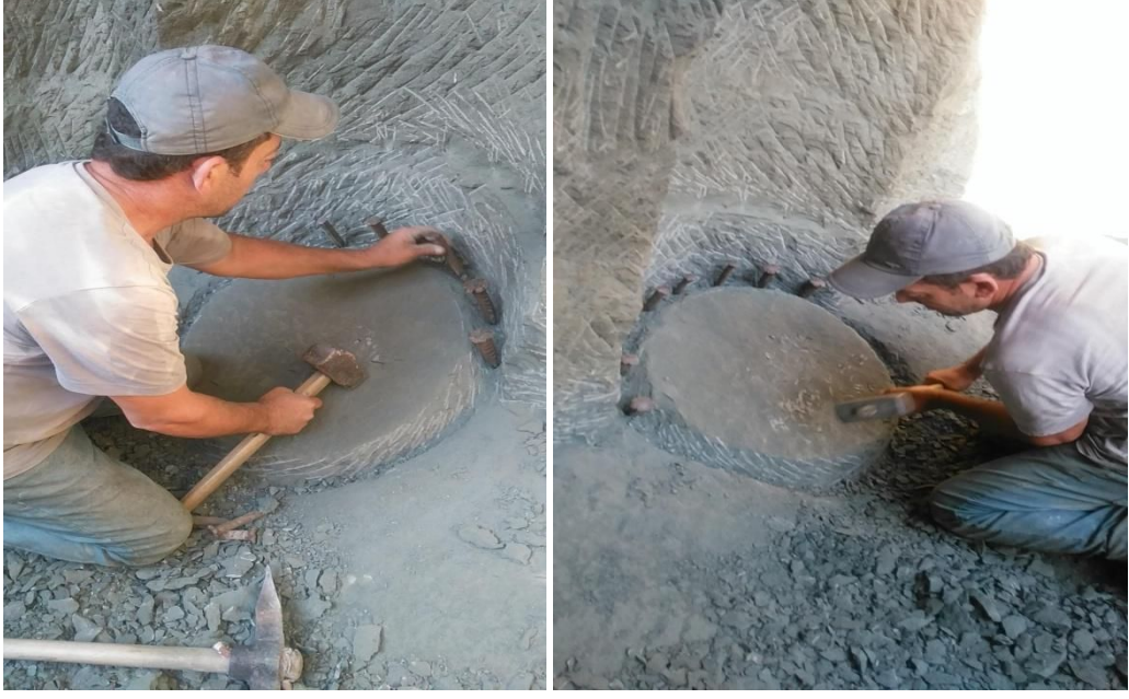
Foto 4: Kesilen kalıbın kenarlarına ivi balyoz takılır
