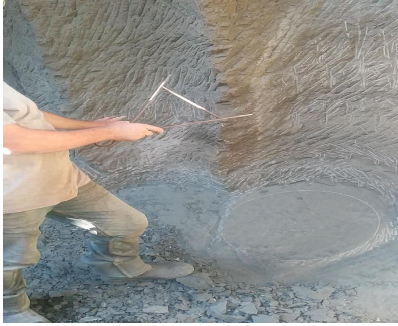
Foto 2: Pergel ile kalıp çizimi
