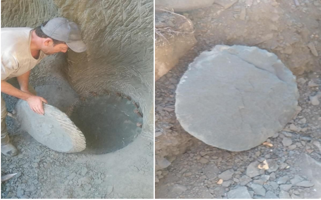
Foto 5: ivi balyozların kalıbın etrafına akılmasıyla kalıp ıkartılır.
