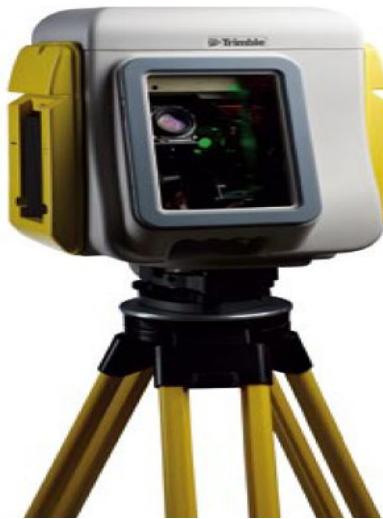
Şekil 38. Trimble Gx 3D Scanner Görünüşü (Ş. Öztürk)
