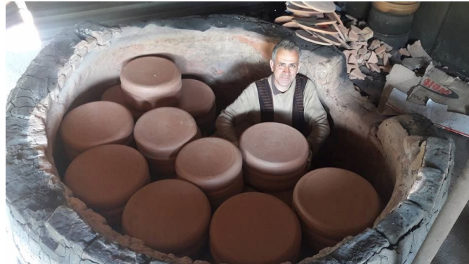
Resim 16. Akçaova Odunlu Fırında Ürünlerin İstiflenmesi ve Fırının Bořaltılması
