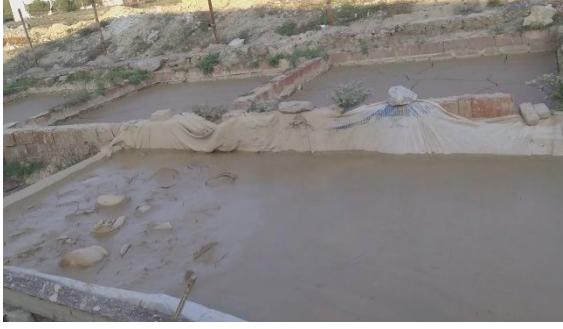
Resim 7. Havuzlarda Sıvı amurun Plastik Hale Gelmesi
