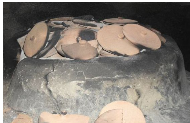
Resim 16. Akçaova Odunlu Fırında Ürünlerin İstiflenmesi ve Fırının Bořaltılması
