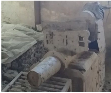
Resim 8. Hazırlanan Plastik amurun Valslerden Geçirilmesi
