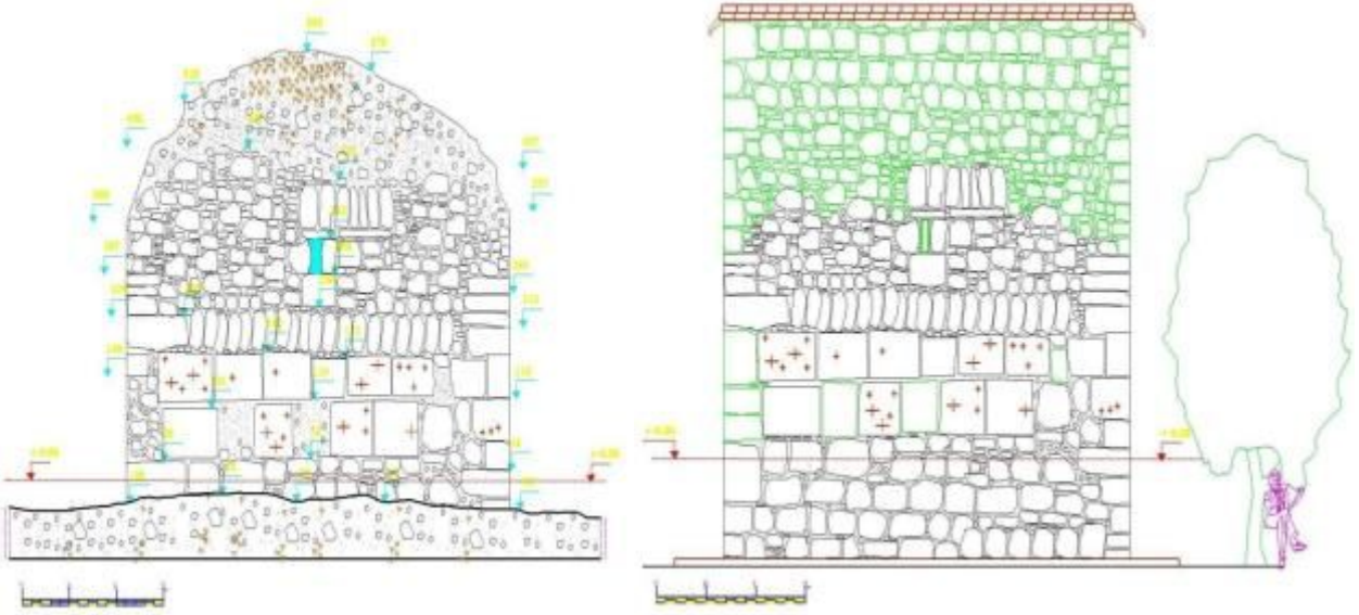
Şekil 10,11. Edremit Kilisesi Doğu Cephe Rölöve-Restitüsyonu (Ş. Öztürk)
