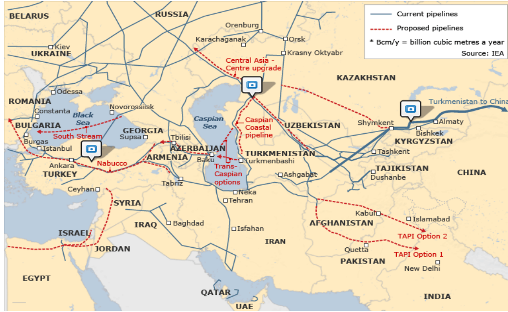
Şekil 14: Mavi düz hatlar mevcut boru hatlarını, kırmızı kesikli çizgiler tasarlanan projeleri göstermektedir.
