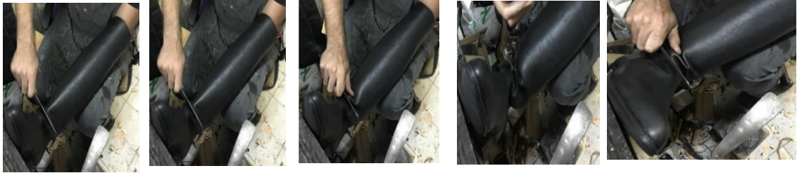
Şekil 102. Körük kırma işlemi ilk aşaması Şekil 103. İlk körüğün oluşturulması Şekil 104. İlk körüğün sıkılması Şekil 105. Körüğün kırılması Şekil 106. İkinci körüğün danalya ile sıkılması
