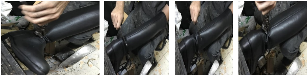
Şekil 107. İkinci körüğün danalya ile sıkılması Şekil 108. Arka körüğün kırılması Şekil 109. İkinci arka körüğün kırılması Şekil 110. Arka körüğün sıkıştırılması
