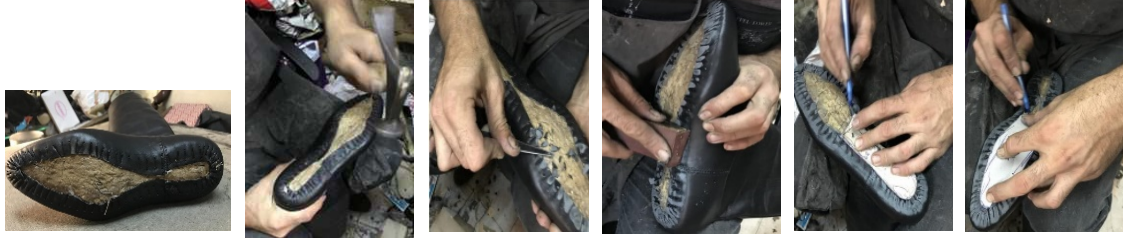
Şekil 50. Çivileri sökülen çizme tabanı Şekil 51. Taban dövme işlemi Şekil 52. Taban derisi inceltme Şekil 53. Taban derisi zımparalama Şekil 54. Topuk kamarası kalıbı Şekil 55. Üst taban kamarası kalıbı
