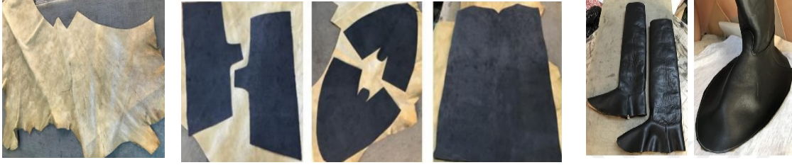
Şekil 16. Astar derisinin hazırlanması Şekil 17. Fort, yüz ve baldır ıstampalarının iç astara yerleştirilmesi ve kesilmesi Yüz ve fort kalıpların kesilmesi Şekil 18. Dikişinden gelen sayalar
