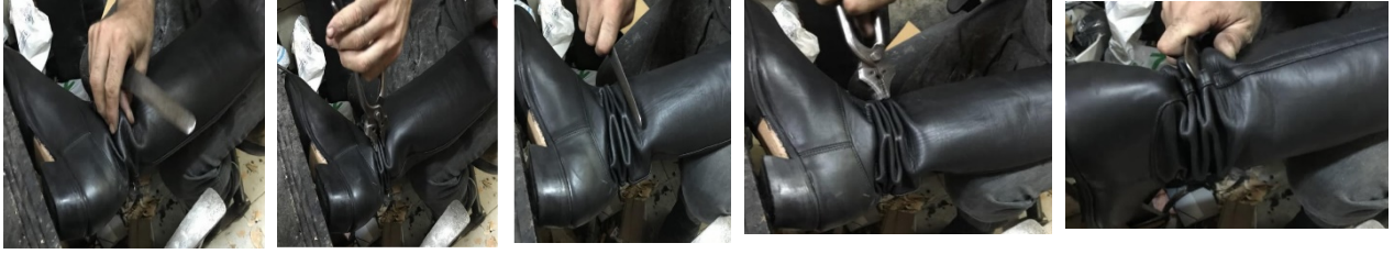
Şekil 111. Üst sıra körüğün kırılması Şekil 112. Danalya ile körüğün sıkıştırılması Şekil 113. Falçata ile körüğün kırılması Şekil 114. Körüğün sıkıştırılması Şekil 115. Körüğün kırılması Şekil 116. Danalya ile körüğün sıkıştırılması
