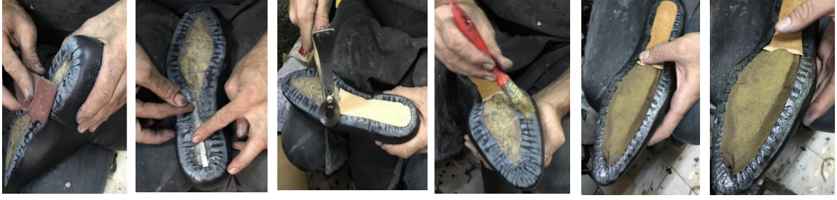
Şekil 73. Köselenin yapıştırılması Şekil 74. Tabanın sabitlenmesi Şekil 75. Taban fazlalığının alınması Şekil 76. Taban kösesinin traşlanması Şekil 77. Filo bıçağı ile traşlama Şekil 78. Topuk yüzeyinin temizliği
