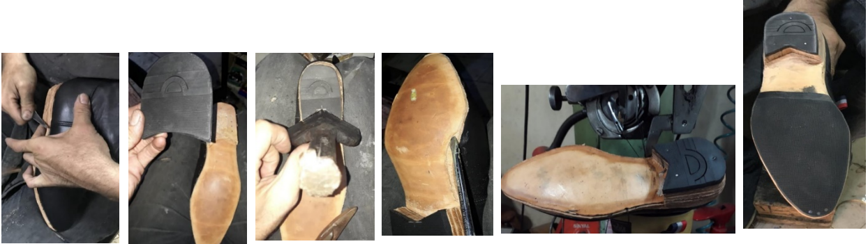
Şekil 85. Son kat topuğun traşlanması Şekil 86. Topuk lastiğinin yapıştırılması Şekil 87. Lastiğinin kesilmesi Şekil 88. Dikiş kanalının açılması Şekil 89. Kenar dikişin yapılması
