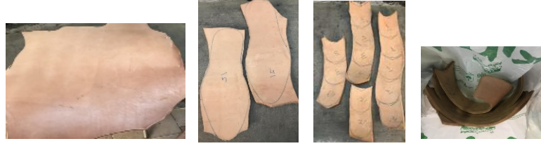
Şekil 46. Taban ve topuk köselesi Şekil 47. Kesilmiş taban köselesi Şekil 48. Kesilmiş topuk köselesi Şekil 49. Kesilmiş taban ve topuk köselesi tavlama işlemi
