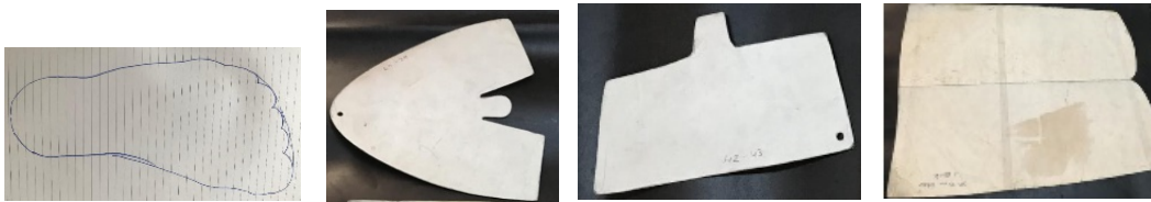
Şekil 8. Ayak kalıbının çıkartılması Şekil 9. Yüz ıstampası Şekil 10. Fort ıstampası Şekil 11. Baldır ıstampası
