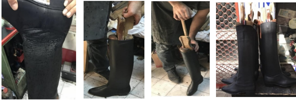
Şekil 98. Çizmelerin ıslatılması Şekil 99. Gambanın yerleştirilmesi Şekil 100. Gambanın sıkıştırılması Şekil 101. Çizmelerin kurumaya bırakılması
