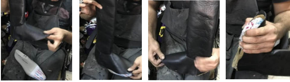
Şekil 28. Kalıba naylon sarılması Şekil 29. Saya yüzeyinin kalıba ortalanması Şekil 30. Saya yüzeyinin kalıba yerleştirilmesi Şekil 31. Saya yüzeyinin kalıba sıkıştırılması
