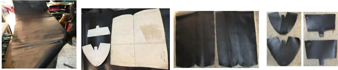
Şekil 12. Saya derisinin hazırlanması Şekil 13. İstampaların yerleştirilmesi Şekil 14. Baldır kalıpların kesilmesi Şekil 15. Yüz ve fort kalıpların kesilmesi
