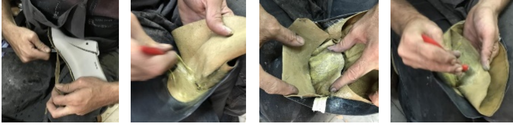
Şekil 24. Taban astarının kesilmesi Şekil 25. Fort astarına yapıştırıcı sürülmesi Şekil 26. Fort astarının yapıştırılması Şekil 27. Sayanın astara yapıştırılması
