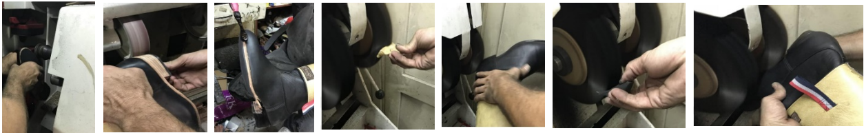
Şekil 90. Topuk ve taban lastiklerine çivilerin çakılması Şekil 91. Topuk ve tabanın frezelemesi Şekil 92. İkinci frezeleme işlemi Şekil 93. Boyama işlemi Şekil 94. Dolgu mumunun sürülmesi Şekil 95. Topuğun fırçalanması Şekil 96. Kenar mumunun sürülmesi Şekil 97. Topuk kösesinin kenar mumu ile fırçalanması
