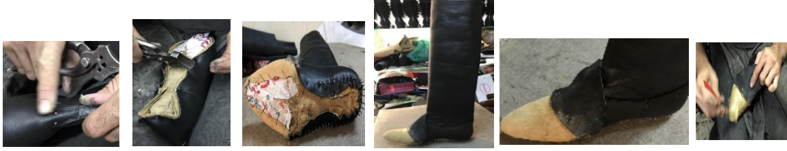
Şekil 32. Dikiş yerlerinden çivileme Şekil 33. Tabanın çivilenmesi Şekil 34. Yüze kadar çivileme işlemi Şekil 35. Yüze kadar çivileme işlemi Şekil 36. Silikon yapıştırıcının sürüleceği yüzey Şekil 37. Silikon yapıştırıcının sürülmesi
