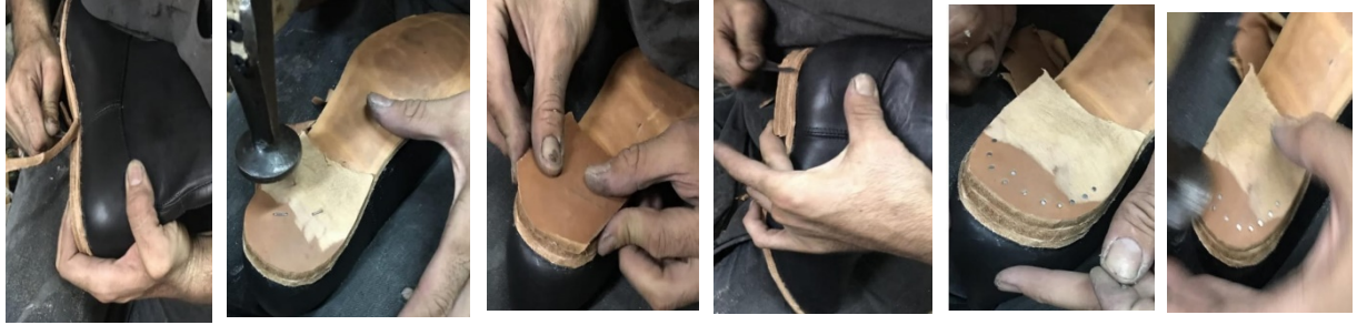
Şekil 79. Topuğun ilk katının yapıştırılması Şekil 80. Topuğun çivilerin çakılması Şekil 81. İkinci katın yapıştırılması Şekil 82. Fazlalıkların temizlenmesi Şekil 83. Kenar çivilerin çakılması Şekil 84. Üçüncü kat çivilerin çakılması
