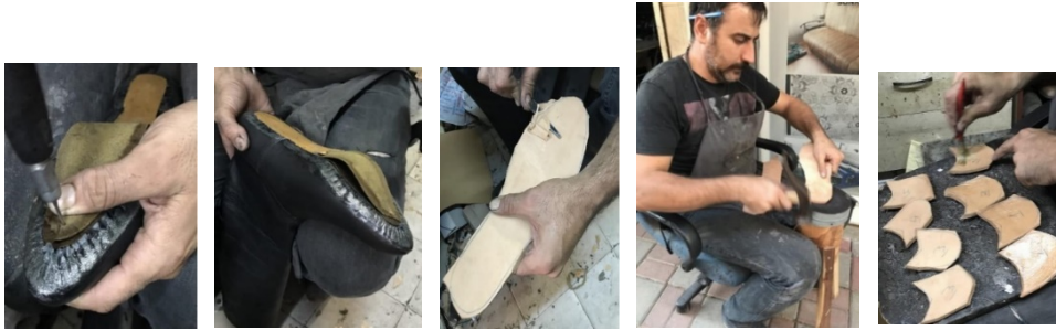
Şekil 62. Tabanın zımparalanması Şekil 63. Kamara demirinin yerleştirilmesi Şekil 64. Topuk kamarasının yapıştırılması Şekil 65. Üst taban kamarasının yapıştırılması Şekil 66. Ahşap çivi çakılması Şekil 67 Ahşap çivinin sabitlenmesi
