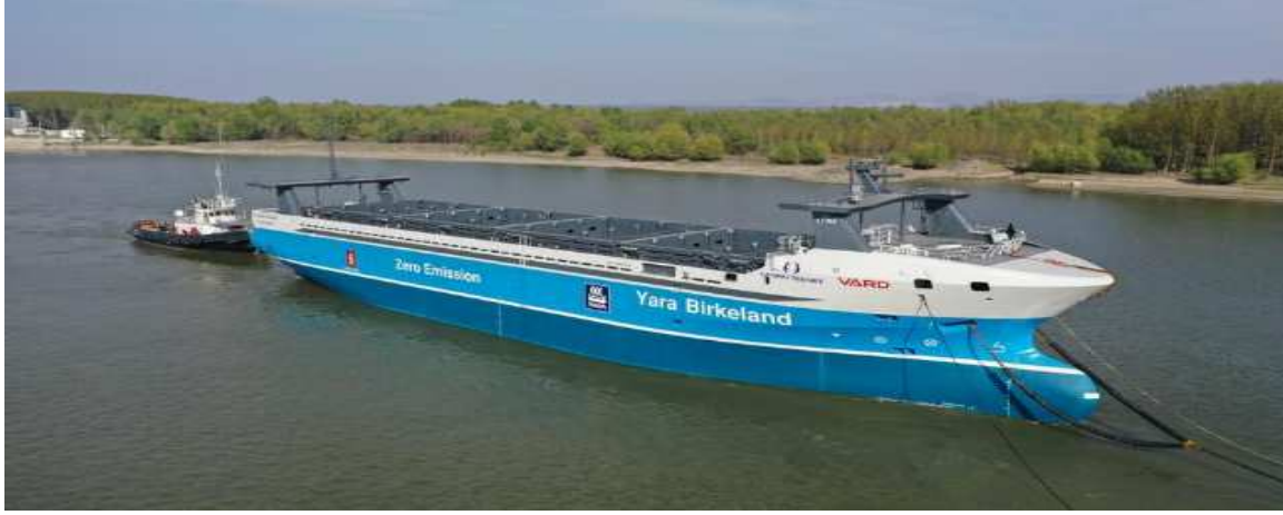
Şekil 6: Yara ve Kongsberg şirketlerinin ortak olarak projesine göre üretilen tam otonom konteyner gemisi, Yara Birkeland . Kaynak: (Yara, 2020)
