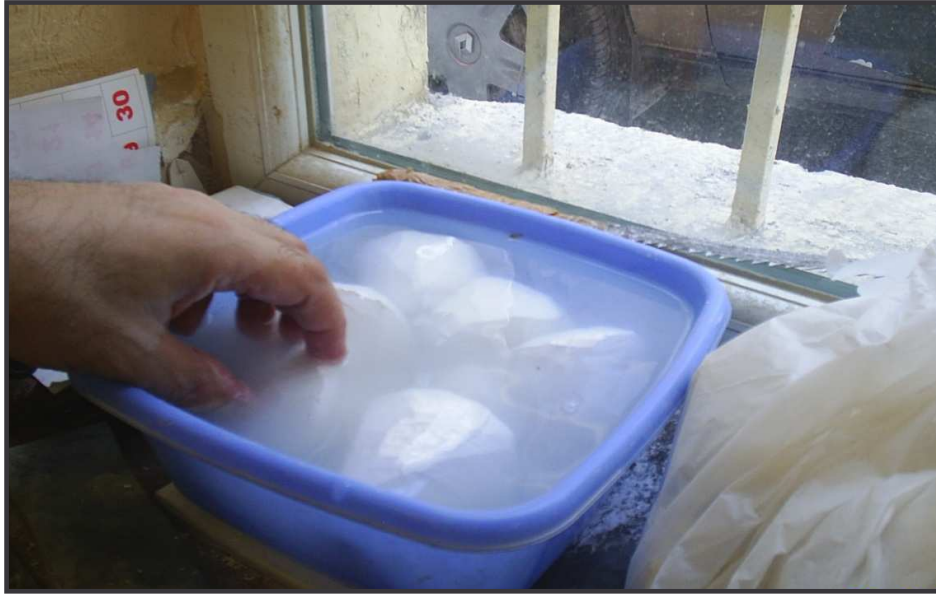
Foto 2: Kolay işlenebilmesi için suda bekletilen lületaşları
