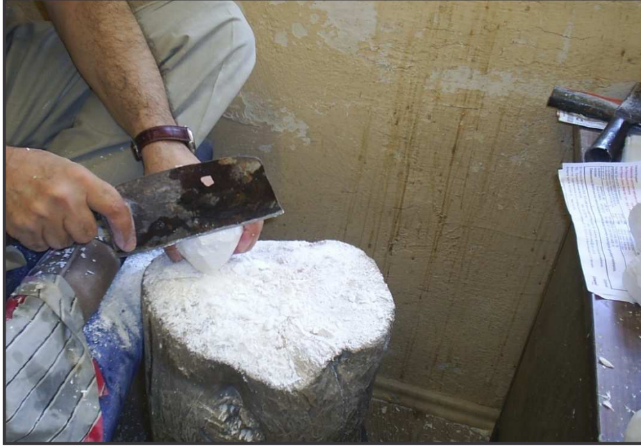
Foto 1: Ham lületaşının işlenmeden önce keserlerle kabaca yontulması
